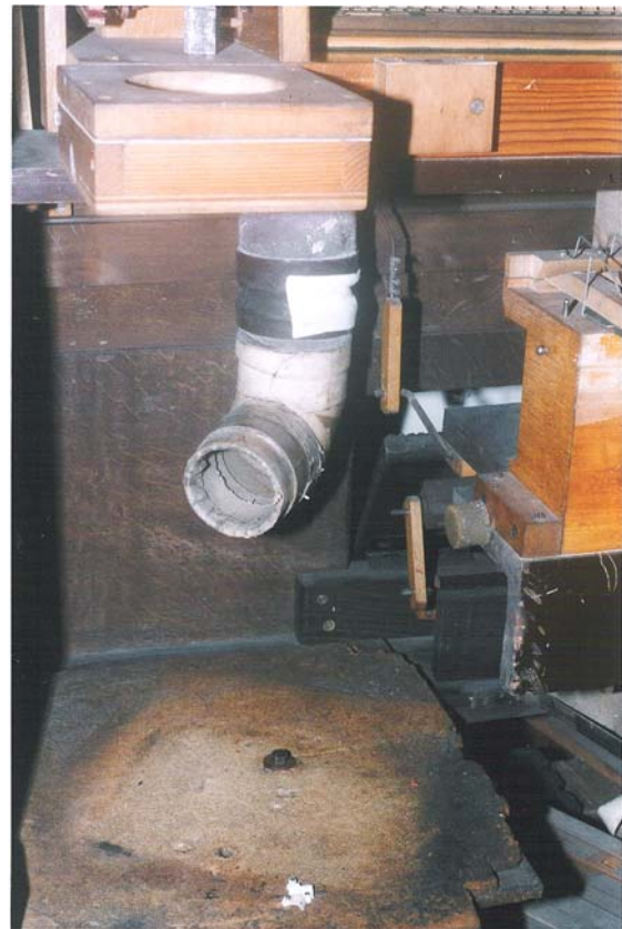
Afb. 5 De luchtpijp van het harmonium
